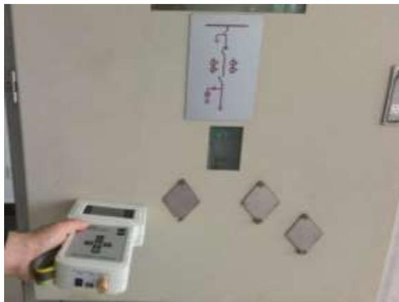
对开关柜的测量是在每一个面板的每一个部件如电缆盒、电流互感器室、母排室、断路器以及电压互感器等的中心位置进行的。
